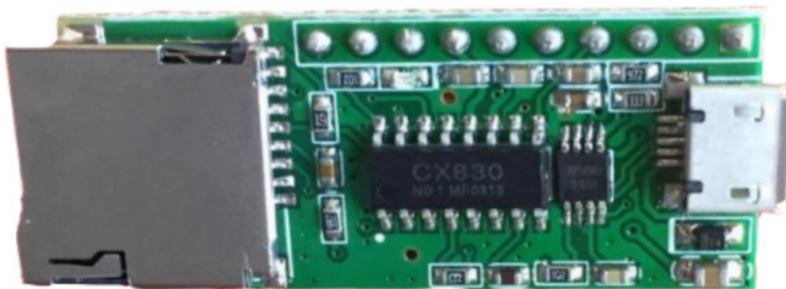
**CX830(-D)M2.0** 采用硬解码的方式,保证系统的稳定性和音质。能够自由更换语音内容和控制方式,使用方便,省去了传统语音芯片需要安装上位机更换语音的麻烦。通过简单的串口指令即可完成指定音乐的播放,多种播放路径。由于成本较低,使用方便灵活,储存的声音内容更长,在市场上得到广泛的应用。
