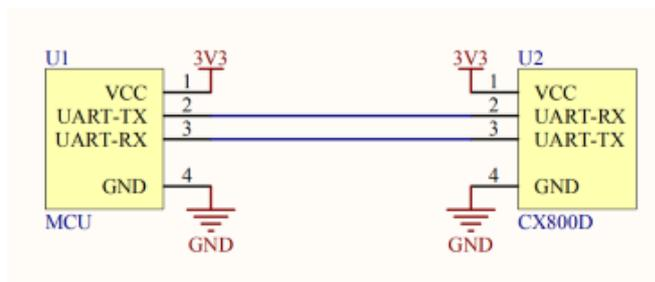
CX830-D 内置 LDO，内部使用 LDO 输出电压 3V3，IO 电压为 3.3V TTL 电平，当 MCU 和 CX830-D 同一供电 3V3 时，IO 电平一致可以直接相连。
