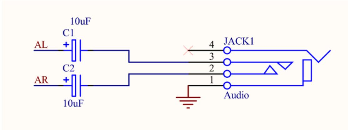
这里C1和C2 为隔直电容，防止外部音源的直流电平影响到芯片内部的偏置；
