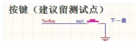
测试引脚用于测试播放，功能是下一曲，当完成电路板后，用于调试硬件，或者故障测试。
