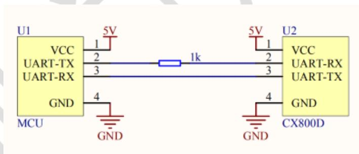
CX830-D 内置 LDO，内部使用 LDO 输出电压 3V3，IO 电压为 3.3V TTL 电平，当 MCU IO 电压为 5V 时和 CX830-D IO 电平不一致不可以直接相连，需做隔离，使用 1K 电阻串联或者使用二极管隔离。
