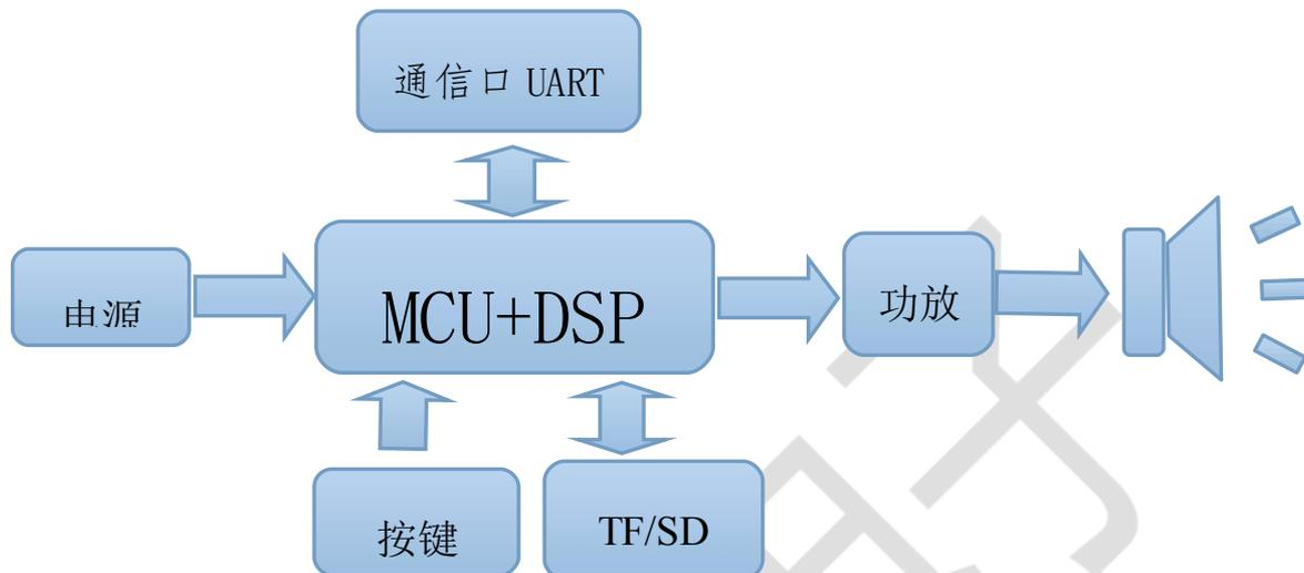
芯片选用的是 SOC 方案，集成了一个 16 位的 MCU，以及一个专门针对音频解码的 aDSP，采用硬解码的方式，更加保证了系统的稳定性和音质。小巧的封装尺寸更加满足嵌入其它产品的需求
