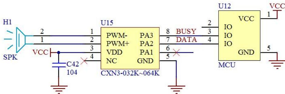
注意：建议 3V 或者 5V 工作时，在单片机 IO 口和 CXN3 IO 口间串一个 470R 的电阻。一线控制时管脚 PA2 为数据输入脚。布线时 VDD 端的电容 C42，要尽量靠近 VDD 管脚，以增强 CXN3 系列语音芯片的抗干扰能力。
