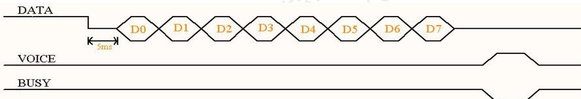
一线串口只通过一条数据通讯线控制时序，依照电平占空比不同来代表不同的数据位。先将数据信号拉低 5ms， 然后发送数据。高电平与低电平数据占空比 1: 3 即代表数据位 0，高电平与低电平数据位占空比为 3:1 代表数据位 1。高电平在前，低电平在后。数据先发低位再发高位，D0~D7 表示一个地址或者命令数据。
