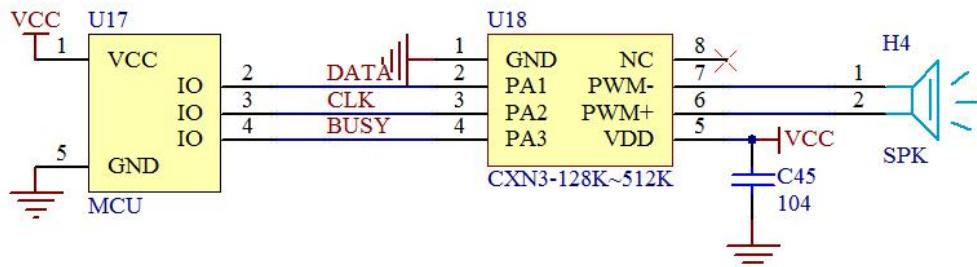
注意：建议 3V 或者 5V 工作时，在单片机 IO 口和 CXN3 IO 口间串一个 470R 的电阻。两线控制时管脚 PA2 为时钟输入脚，PA1 为数据输入引脚。布线时 VDD 端的电容 C45，要尽量靠近 VDD 管脚，以增强 CXN3 系列语音芯片的抗干扰能力。
