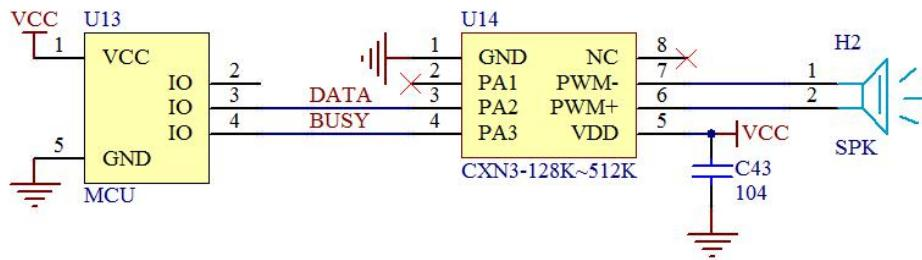
注意：建议 3V 或者 5V 工作时，在单片机 IO 口和 CXN3 IO 口间串一个 470R 的电阻。一线控制时管脚 PA2 为数据输入脚。布线时 VDD 端的电容 C43，要尽量靠近 VDD 管脚，以增强 CXN3 系列语音芯片的抗干扰能力。
