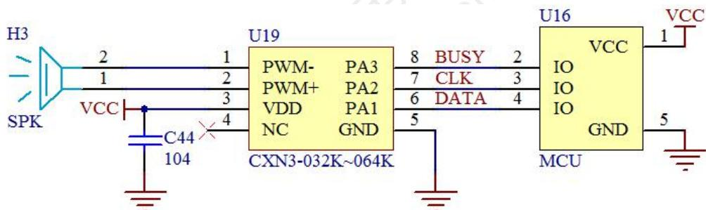
注意：建议 3V 或者 5V 工作时，在单片机 IO 口和 CXN3 IO 口间串一个 470R 的电阻。两线控制时管脚 PA2 为时钟输入脚, PA1 为数据输入引脚。布线时 VDD 端的电容 C44，要尽量靠近 VDD 管脚，以增强 CXN3 系列语音芯片的抗干扰能力。
