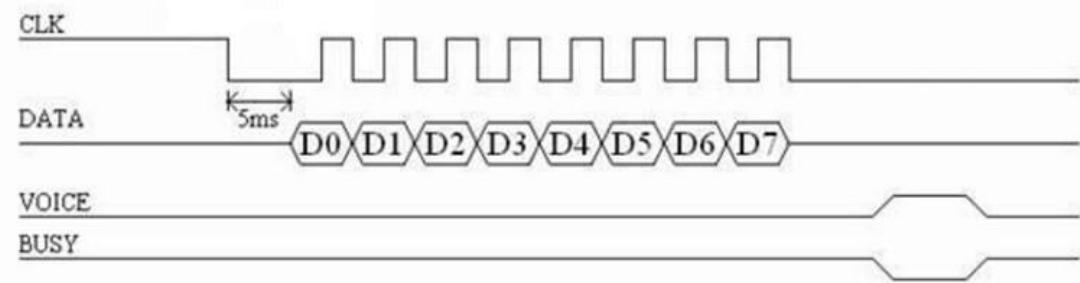
两线串口控制模式由片时钟 CLK 和数据 DATA 脚组成，每发一个字节数据，时钟信号 CLK 拉低 4ms 至 40ms，推荐使用 5ms 以唤醒 CXN3 语音芯片，接收数据低位在先，在时钟的上升沿接收数据。时钟周期介于 320us~1.5ms 之间，，推荐周期使用 400us，。发数据时先发低位，再发高位。D0~D7 表示一个语音地址或者命令数据。
